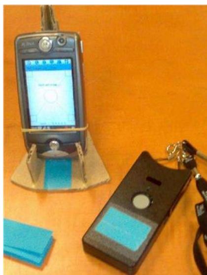
図1. Meeting Mediator。ソシオメトリックバッジ（右下）がグループ・ダイナミクスを捉え、それが携帯電話（左上）にリアルタイムでフィードバックされる。
